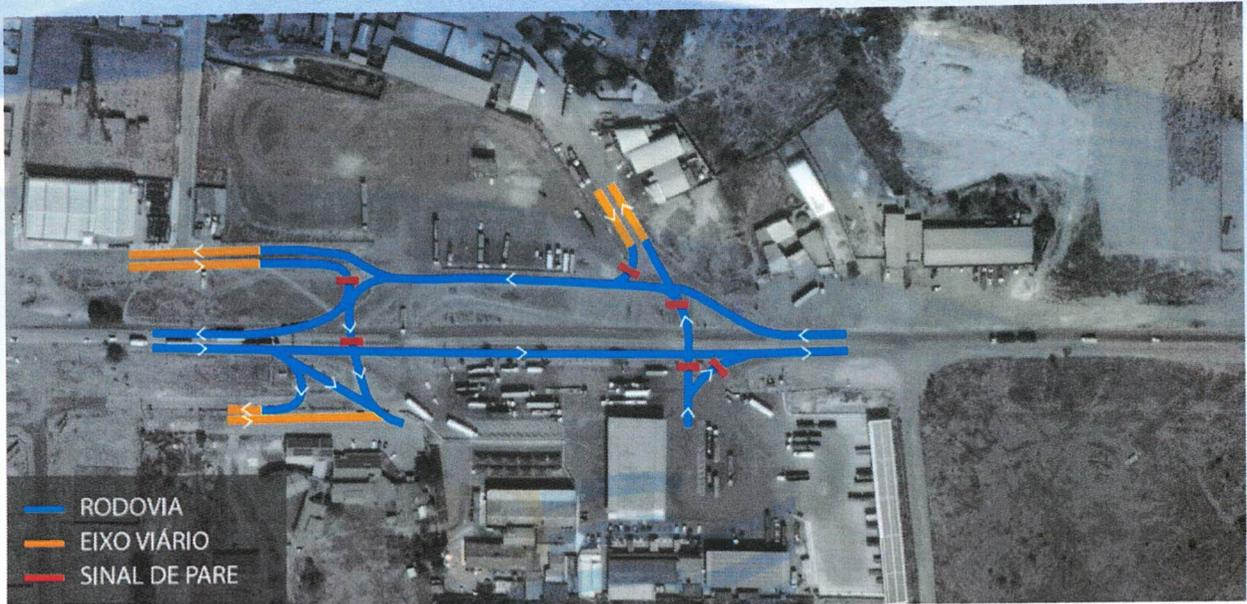
**Figura 2.5 – Esquema da solução proposta para o dispositivo em frente ao Posto JK.**
