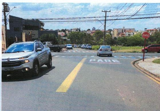
**Figura 3.10 – Linha amarela simples separando fluxos opostos em cruzamento.**
