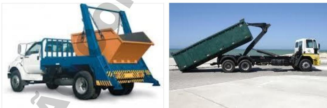
Figura 9: Formas de transporte adequado de RCC
